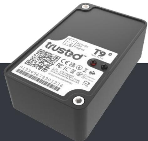
Ce modèle Bluetooth est doté d'une **connectivité Bluetooth** et fonctionne en parfaite harmonie avec l'application Trusted Data. Il intègre la technologie de communication LTE Cat-M1 pour des transmissions sur les réseaux mobiles internationaux.
