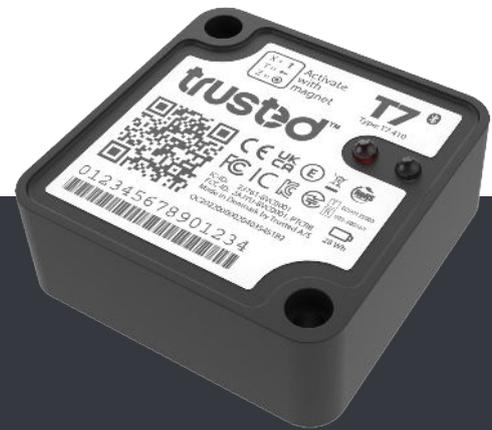
Le modèle **T7 Bluetooth®** est un dispositif de suivi IoT et de journalisation des données de petite taille conçu pour le suivi des données et la surveillance des actifs tels que les outils, les équipements, le fret et des flottes entières.
